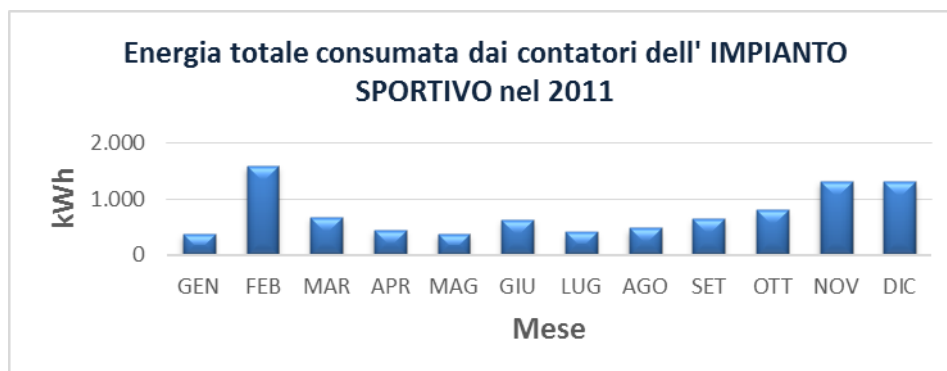
Figura 3.1.5.1 Totale di energia elettrica consumata dai contatori dell' IMPIANTO SPORTIVO per kWh/mese nell'anno 2011
